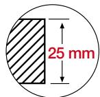
massimo spessore di fissaggio
