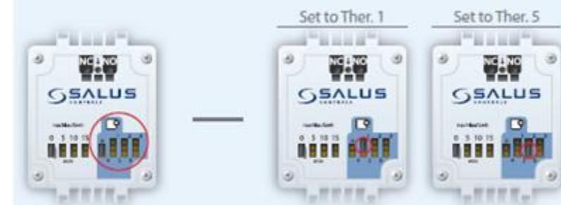
11 • Zvoľte termostat u ktorého sa má aktivovať čas dobahu. Potom nastavte jumper. Existuje možnosť výberu buď všetkých termostatov (p), alebo termostatu 1-6.
