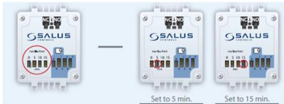
10 • Stanovte požadovanú dobu dobahu čerpadla. Za týmto účelom nasadte jumper do príslušnej polohy. Existuje možnosť voľby 5, 10 a 15 minút.
