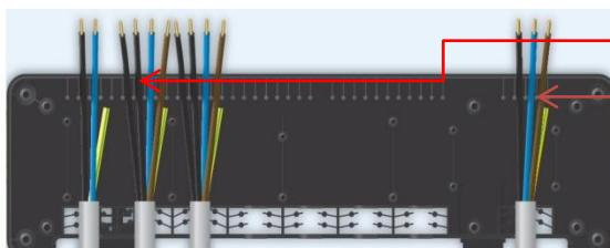
Následne k zadnej časti svorkovnice (čierny plášť) primontujte inštalačné vodiče napäťia 230V, servopohonov, regulátorov buď modul PL06, alebo PL07. Činnosť je nutné vykonať podľa obrázku uvedeného vedľa. Vodič je nutné upevniť podľa konečného pripojenia – vidieť schéma zapojenia v ďalšej časti návodu.
