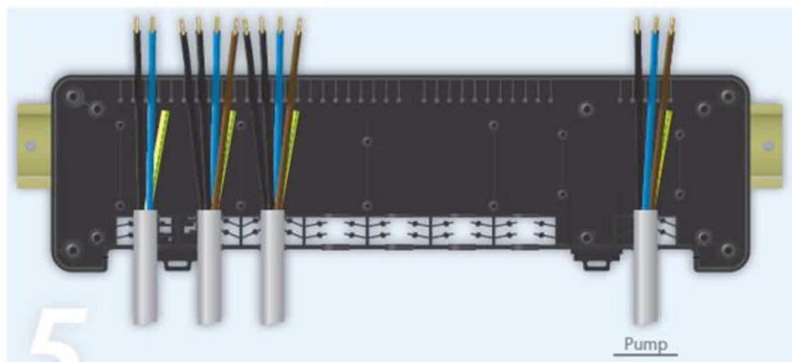
5 • V prípade použitia modulu logiky čerpadla (zariadenie objednajte samostatne) namontujte vodič čerpadla do základne podľa vyššie uvedenej ilustrácie.
