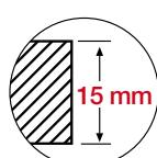
massimo spessore di fissaggio
